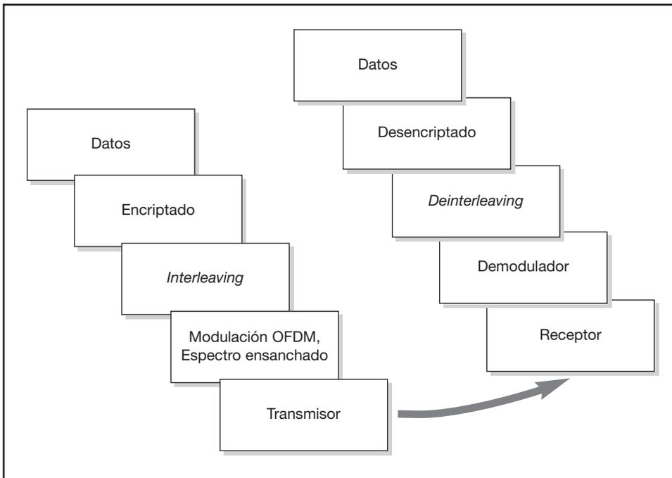
Figura 6. Esquema lógico de técnicas de seguridad.
