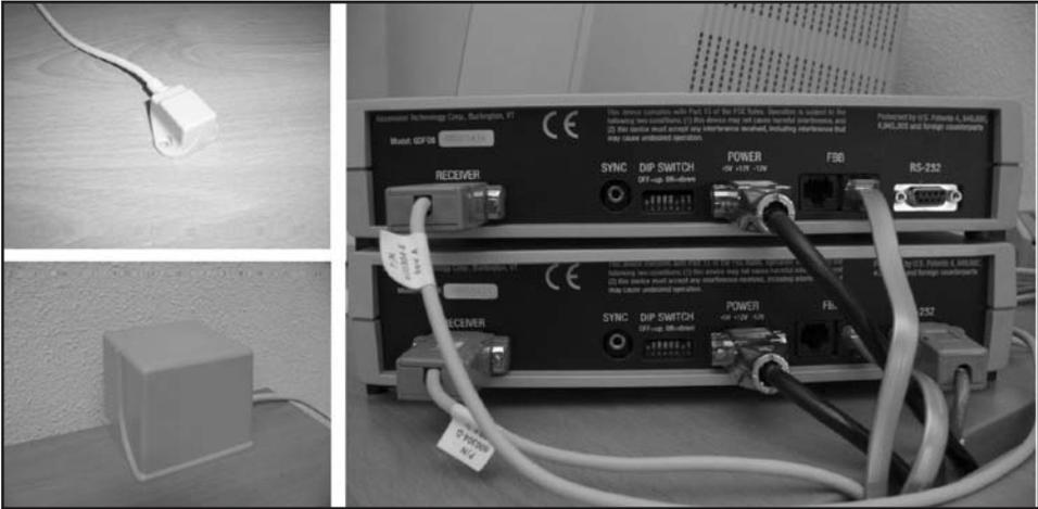
**Figura 2.** Ejemplo de rastreador electromagnético (de izquierda a derecha, y de arriba y abajo: rastreador, unidad de control y emisor).
