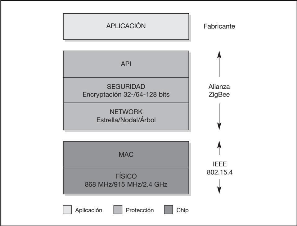
**Figura 5.** Torre de protocolos asociada a ZigBee.
